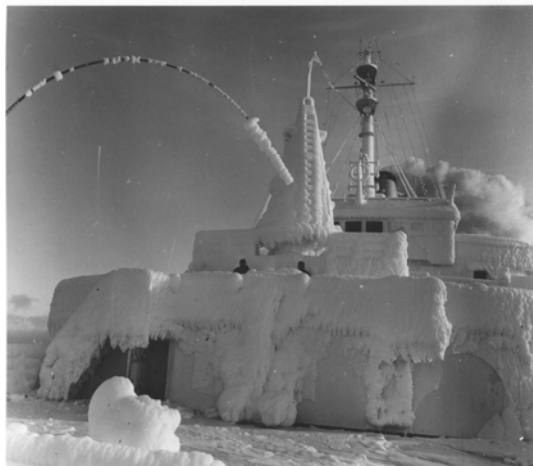
Figure 3. Example of icing in North Atlantic.(Photo: Kpt. Ż.W. Hieronim Majek)
