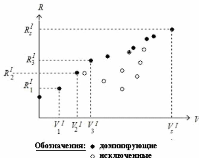
**Шаг 3б.** Аналогичная процедура повторяется для Таблицы 3. Все пары  $\{R_3(x_3)*R_4(x_4); v_3x_3 + v_4x_4\}$  упорядочиваются, как и ранее, затем производятся аналогичные исключения, и в результате получается доминирующая последовательность вида:  $\{R_1^II, V_1^II\}, \{R_2^II, V_2^II\}, \dots, \{R_j^II, V_j^II\} \dots$
